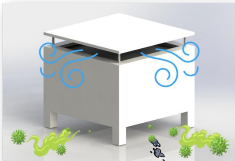
Funktionsweise: Ansaugung unten, gefilterte Luft strömt oben raus
